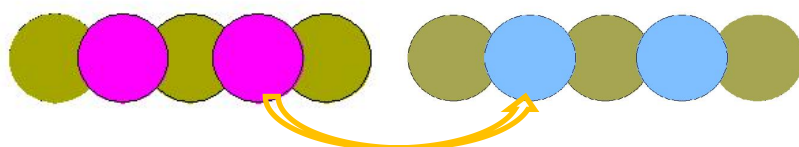
微膨胀水下流态固化土咬合桩 (止水桩由素混凝土优化为流态固化土)
